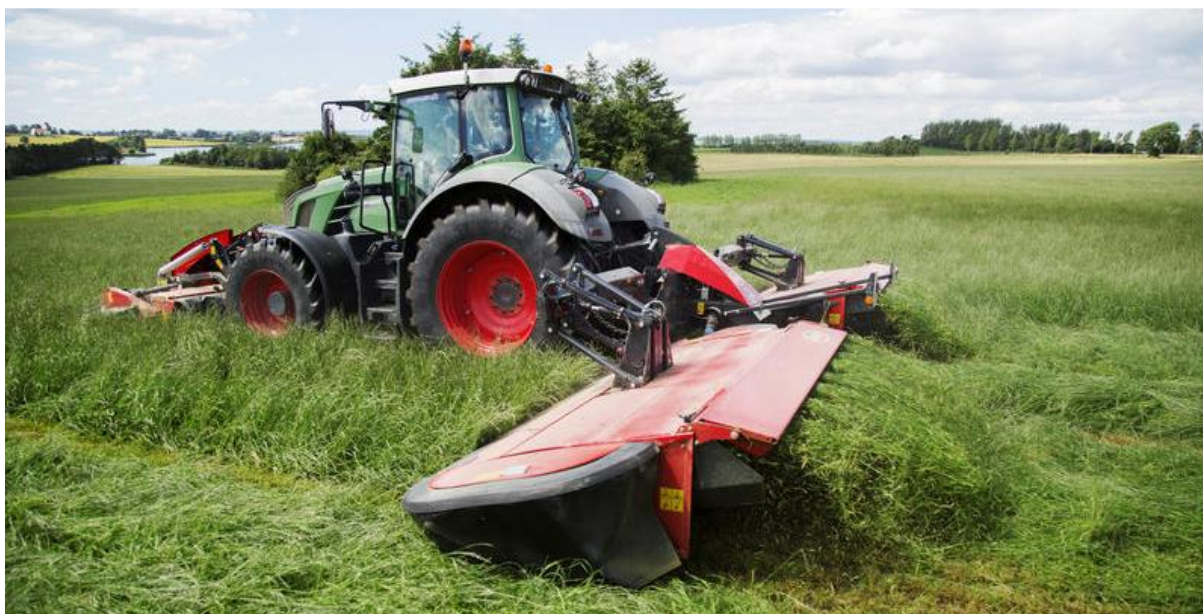
GEOMOW de Vicon optimiza solape entre las segadoras frontales y traseras para maximizar el rendimiento
